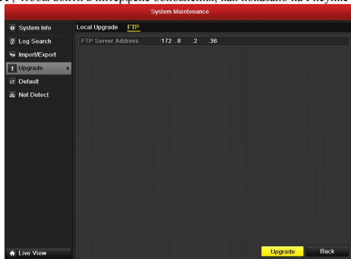
Рисунок 12. Интерфейс обновления с использованием FTP
