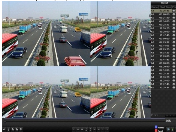
Рисунок 6. Интерфейс одновременного воспроизведения 4-х каналов со списком файлов
