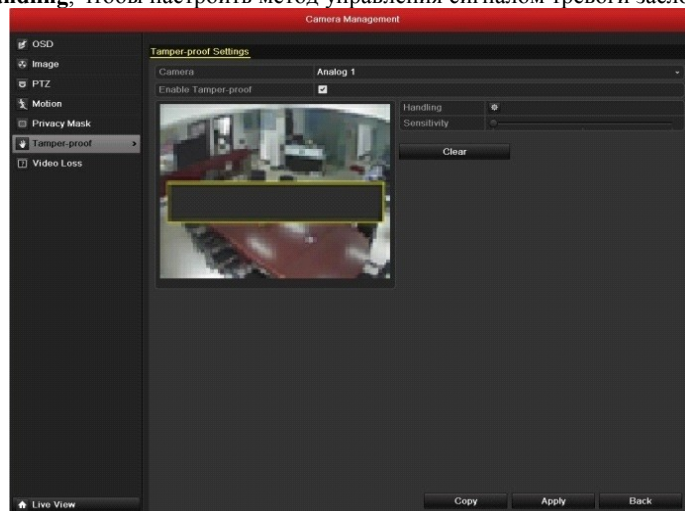
Рисунок 8. Установка зоны и чувствительности детекции заслона обзора
