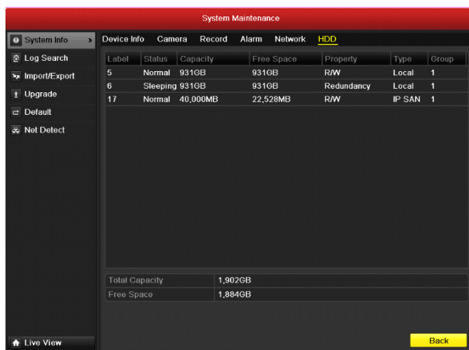
Рисунок 10. Проверка статуса HDD (2)
