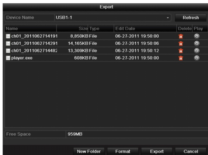
Рисунок 7. Проверка результатов экспорта видеоклипов с использованием USB Flash Drive
