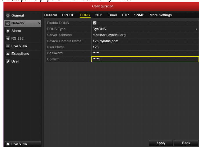
Рисунок 9. Интерфейс конфигурации DynDNS
