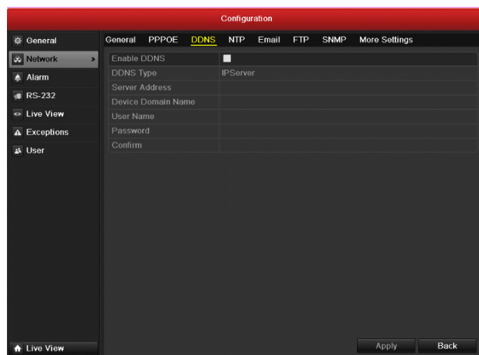
Рисунок 9. Интерфейс конфигурации DDNS
