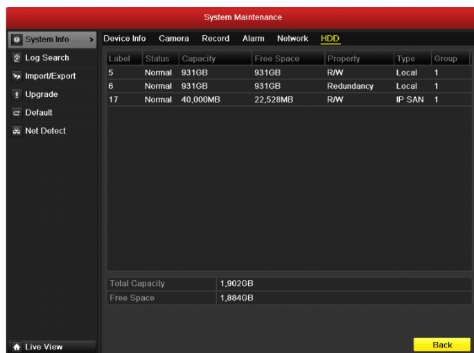
Рисунок 12. Интерфейс информации HDD
