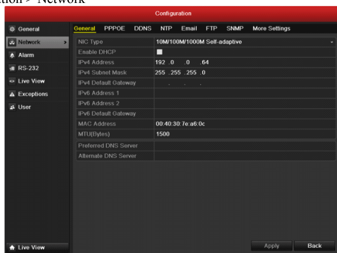
Рисунок 9. Интерфейс сетевых настроек
