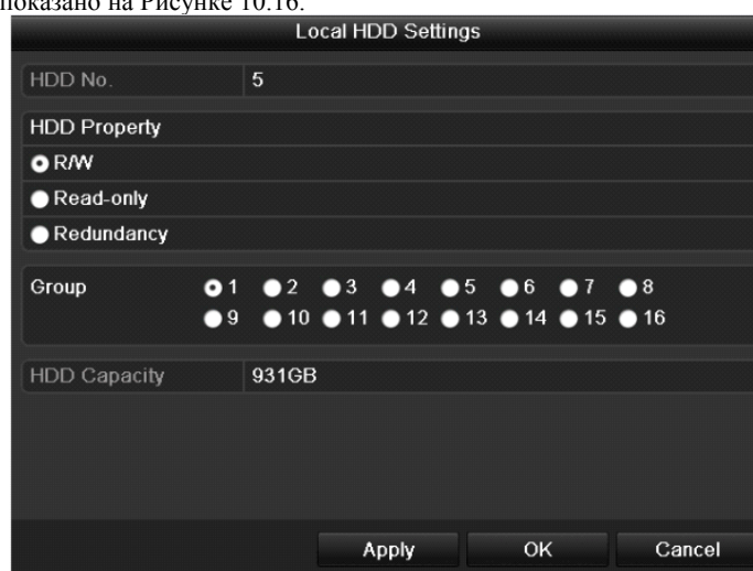
Рисунок 10. Установка свойств жесткого диска
