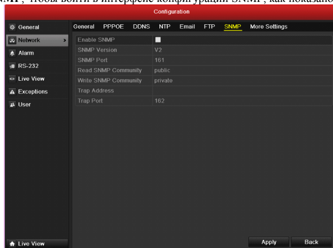
Рисунок 9. Интерфейс конфигурации SNMP
